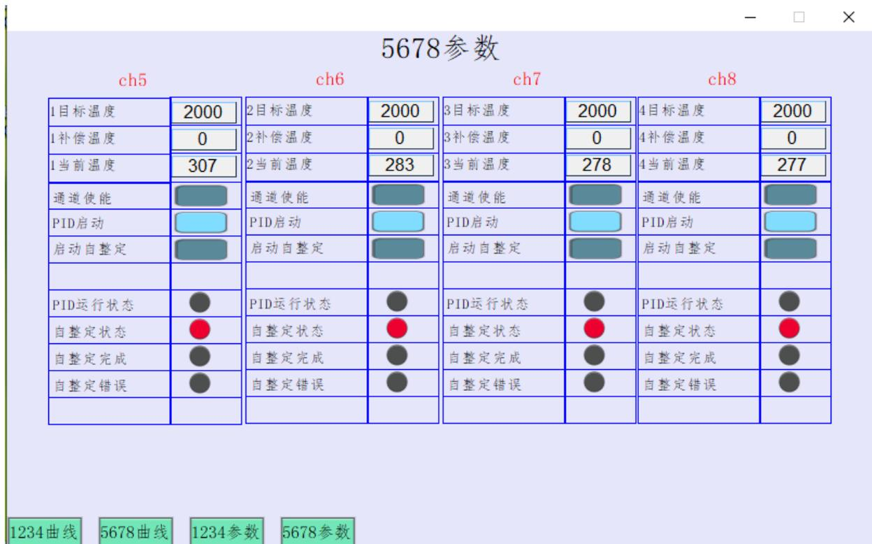
3) 自整定完成后，自整定完成状态接通，模块进入PID运行状态
