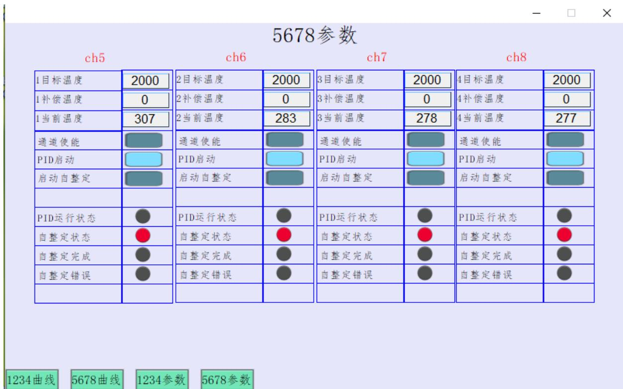
自整定完成后，自整定完成状态接通，模块进入PID运行状态
