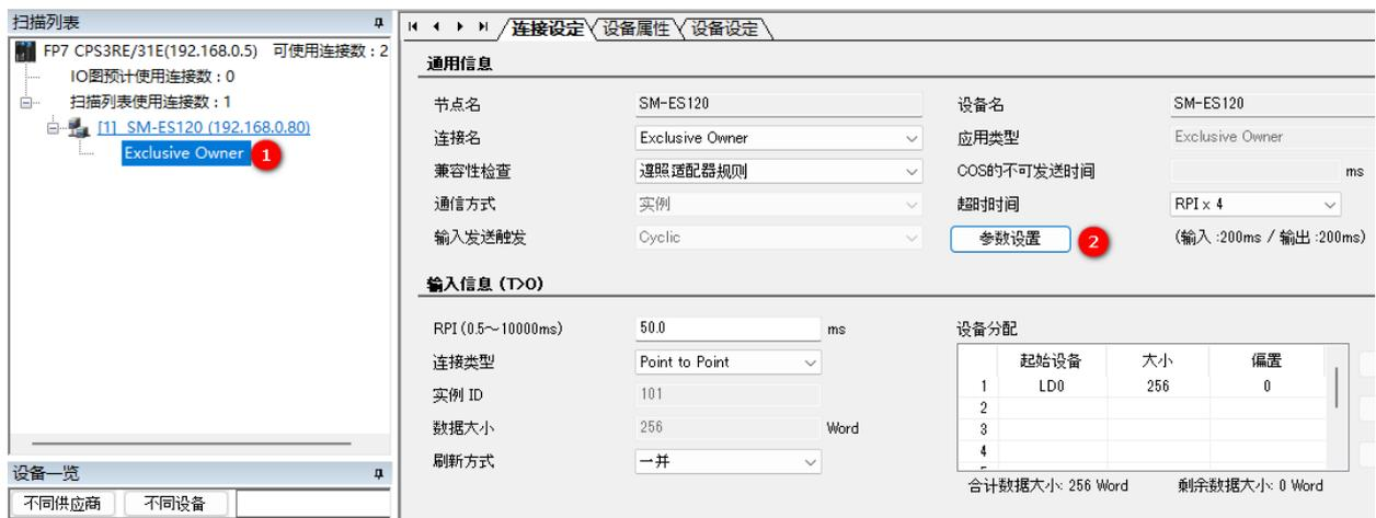
注意事项：输入字节和输出字节必须要和实物的占用的字节数一致，模块型号顺序和实际安装型号要一致。
